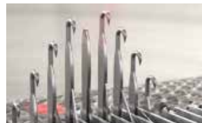
Kırılmış iğneleri anında tespit eder
